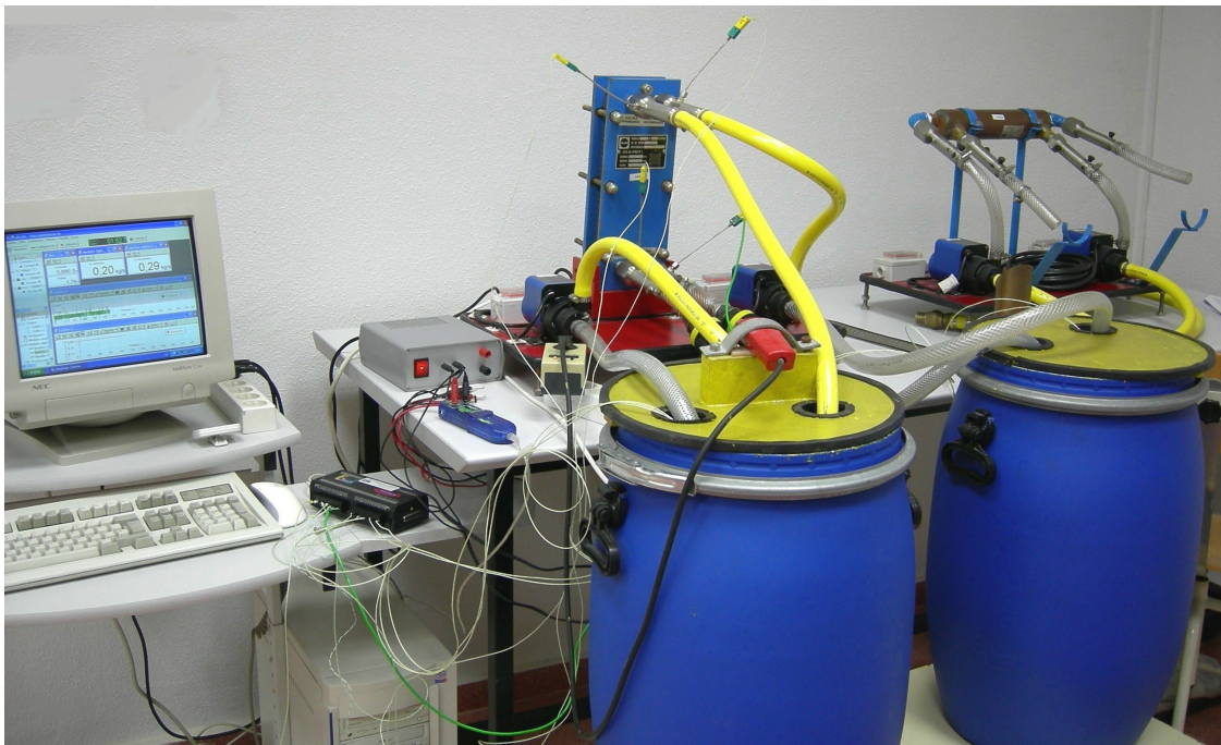
Fig. 3. Montaje de la práctica del intercambiador de placas
