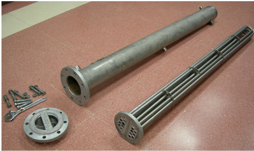
Fig. 2. Intercambiador de 2 pasos desmontado
