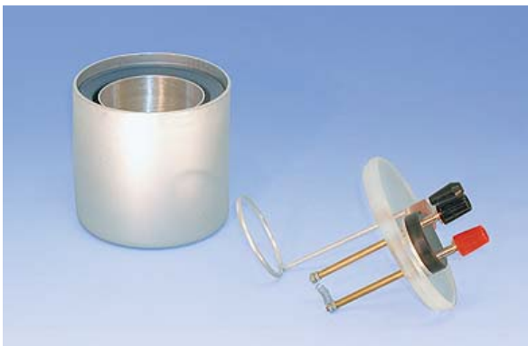
Fig. 3. Calorímetro: foto, esquema y extrapolación de la evolución de la temperatura para tener en cuenta las pérdidas de calor durante el proceso.
