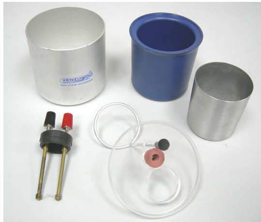
Fig. 2. Montaje e instrumentación calorímetro.
