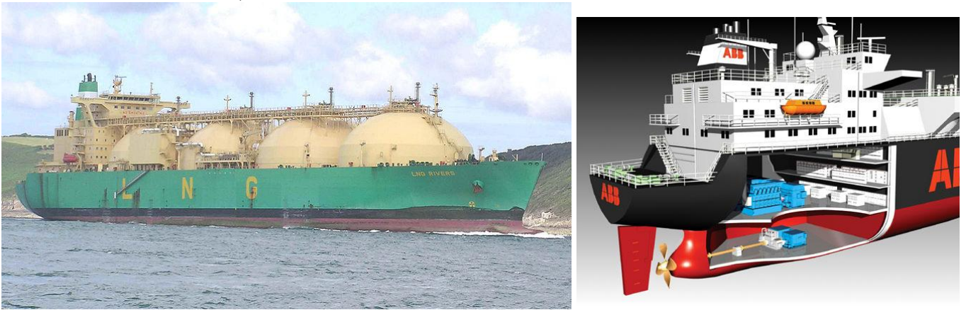
Fig. 3. a) LNG motorised by a 32 MW steam turbines . b) Sketch of a 40 MW LNG dual-fuel electric propulsion system ( ABB ).
