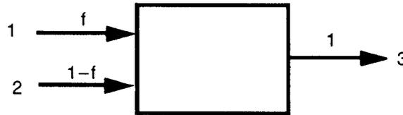
Fig. 16.10. Esquema de flujos de entrada y salida a un combustor adiabático en el que tiene lugar una combustión completa.
