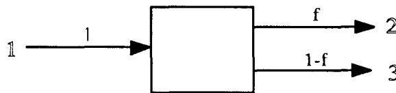
Fig. 7.3. Esquema de fraccionamiento de una corriente 1 en dos flujos, uno rico f y otro pobre 1-f en el componente deseado de la mezcla inicial que entra por 1.
