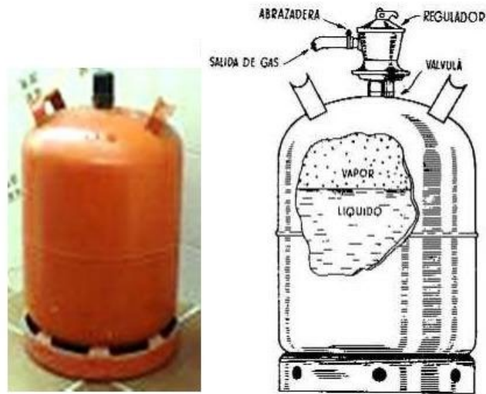
Fig. 1. Bombona de butano y esquema de su interior.
