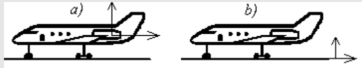
Fig. E2.14. Movimiento relativo: a) ejes ligados al avión, b) ejes ligados a la pista.
