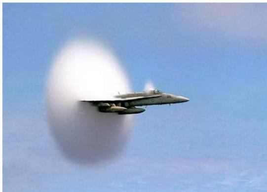
Fig. 16. Condensación por depresión inducida en vuelo ([NASA](#)).
