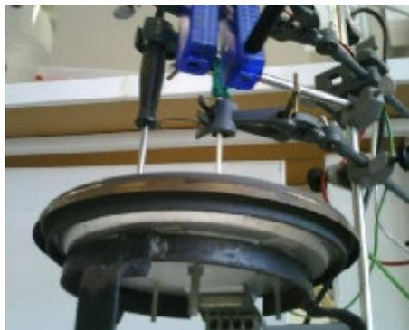
Fig. 2. Termografías de la placa calefactora (de 18 cm de diámetro) desde arriba y desde abajo, y fotografías correspondientes. En la vista desde abajo se puede apreciar el calentamiento de los sensores de carcasa azul (un radiómetro y un termómetro de infrarrojos). En las fotos se ven también dos termómetros de contacto (varillas con mangos negros)
