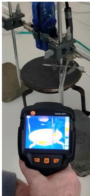
Fig. 8. Cámara termográfica Testo-871 apuntando a la placa calefactora.
