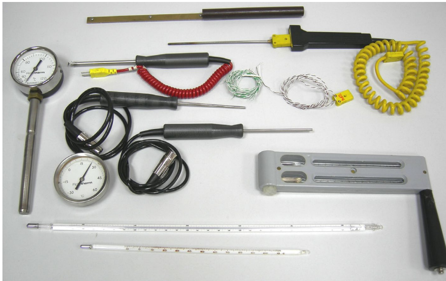
Fig. 2. Diferentes sensores de temperatura; de izquierda a derecha y de abajo a arriba: termómetros de tubo capilar, higrómetro de onda, termómetro de presión de vapor, termómetro bi-metal, termorresistencia, termistor, termopares, bi-metal.
