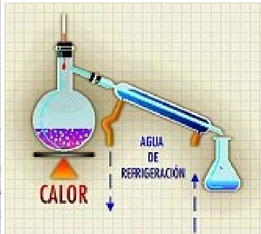
Fig. 4. Entalpía de vaporización en destilador.
