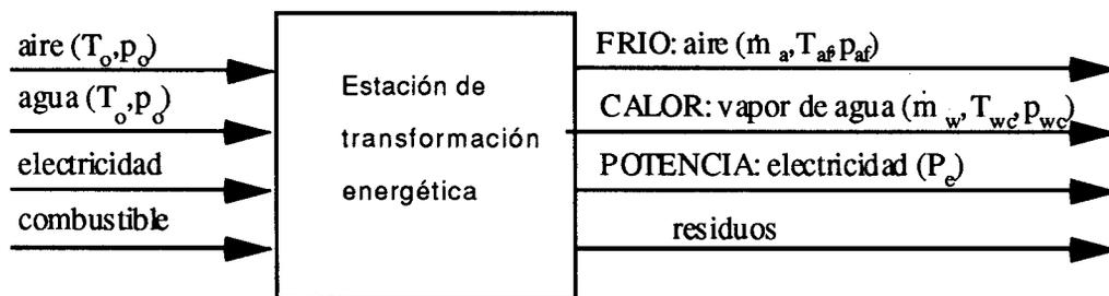
Fig. 19.5. Esquema de entrada/salida para una típica estación de transformación energética.
