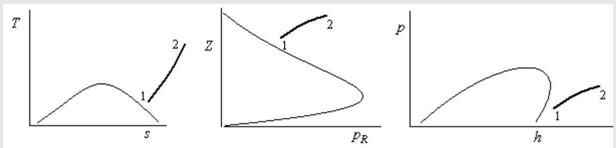
Fig. E5.3.1. Esquema de la evolución isocora.
