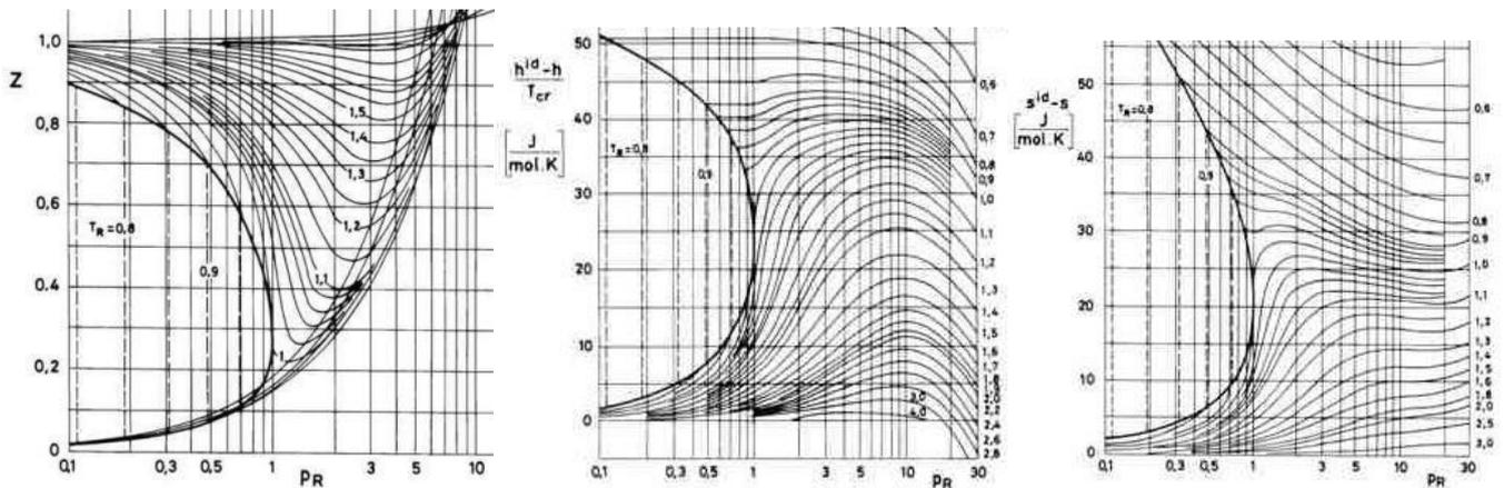
Fig. 5.7. Diagramas de estados correspondientes (MEC): a) [factor de compresibilidad](#), b) [correcciones a la entalpía](#), c) [correcciones a la entropía](#).
