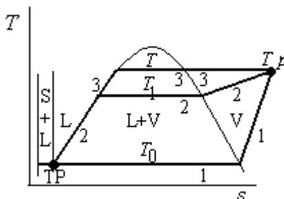
Fig. 5.9. Diversos caminos que pueden seguirse para el cálculo de las propiedades no absolutas (en este ejemplo la entropía) de un estado gaseoso a partir de un estado de referencia líquido (e.g.  $h=s=0$  en el punto marcado como TP).
