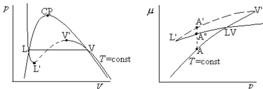
Fig. 5.10. a) Estados estables, metaestables (LL' y VV'), e inestables (L'V') a lo largo de un proceso isotermo con cambio de fase (e.g. una isoterma de van der Waals), y discontinuidad de los estados de equilibrio (línea horizontal). b) Variación del potencial químico con la presión a lo largo del proceso isotermo incluyendo los estados metaestables (e.g. a lo largo de una isoterma de van der Waals).
