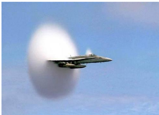
Fig. 16. Condensación por depresión inducida en vuelo ( NASA ).
